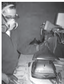
Ilustración 63: Separar el tubo de imagen. Foto: MAVDT.
