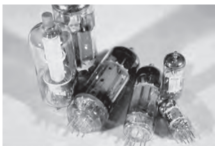
Ilustración 56. Tubos de vacío o amplificadores. Foto: eag-leitfaden.
