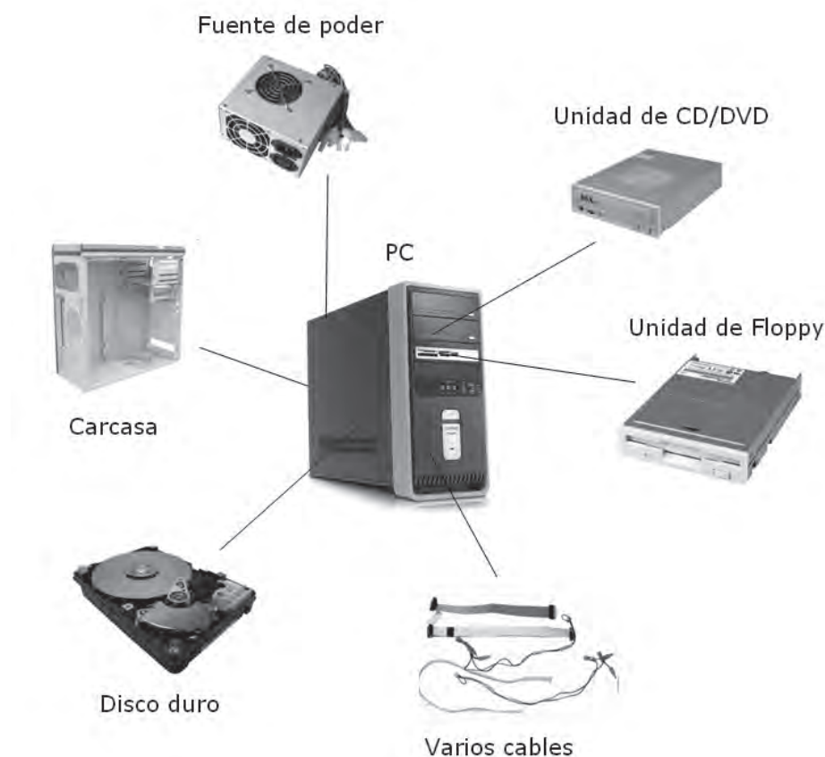
Ilustración 38: Un computador de escritorio y sus principales componentes.
