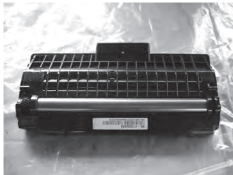
Ilustración 97: Tambor fotoconductor montado. Foto: MAVDT
