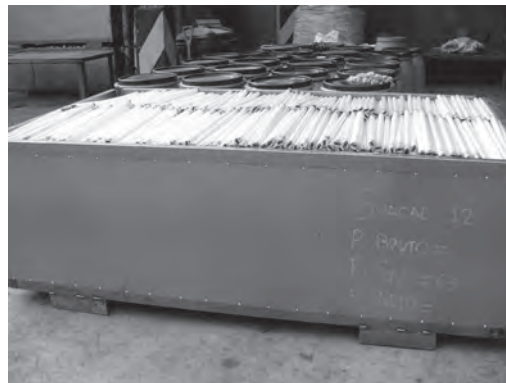
Ilustración 92: Contenedor seguro para el transporte de tubos fluorescentes. Foto: MAVDT.
