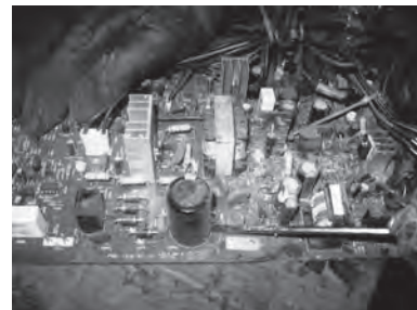
Ilustración 76: Destornillar de un condensador. Foto: MAVDT
