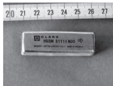
Ilustración 90: Interruptor de mercurio. Foto: eag-leitfaden.
