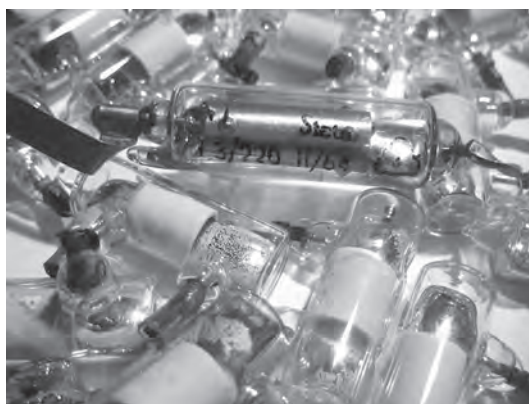
Ilustración 86: Antiguos interruptores de mercurio. Fuente: Wikipedia.
