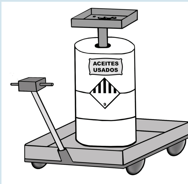
Figura 2. Recipiente para drenaje de aceites usados
