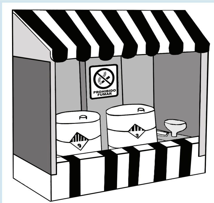
Figura 5. Almacenamiento en tambores de los aceites usados (gestión interna)
