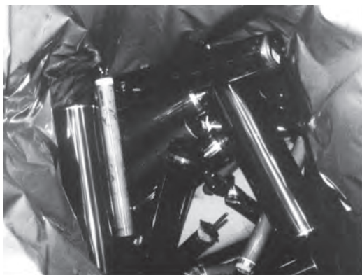
Ilustración 98. Tambores fotoconductores OPC. Foto: eag-leitfaden.
