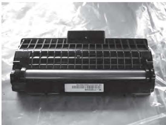
Ilustración 59: Cartucho de tóner con tambor fotoconductor.
