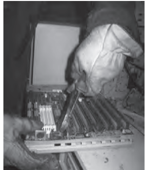
Ilustración 102: Separar la pila de respaldo. Foto: MAVDT
