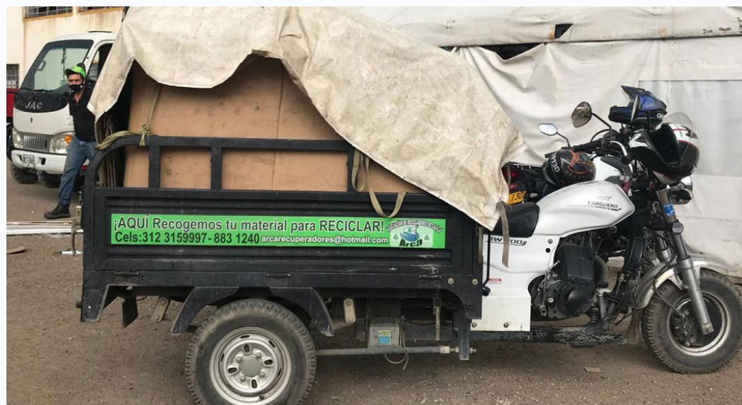
Ejemplo de cubierta para el transporte de material. Fuente: Gerdau Diaco.
