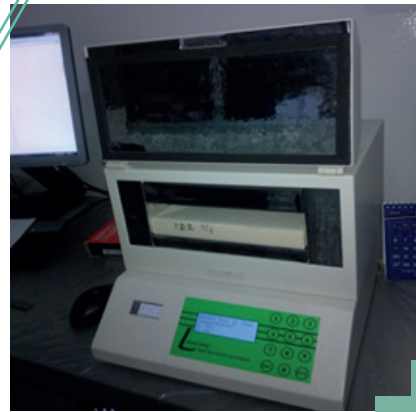
Fotografía 3. Determinación de factor k
