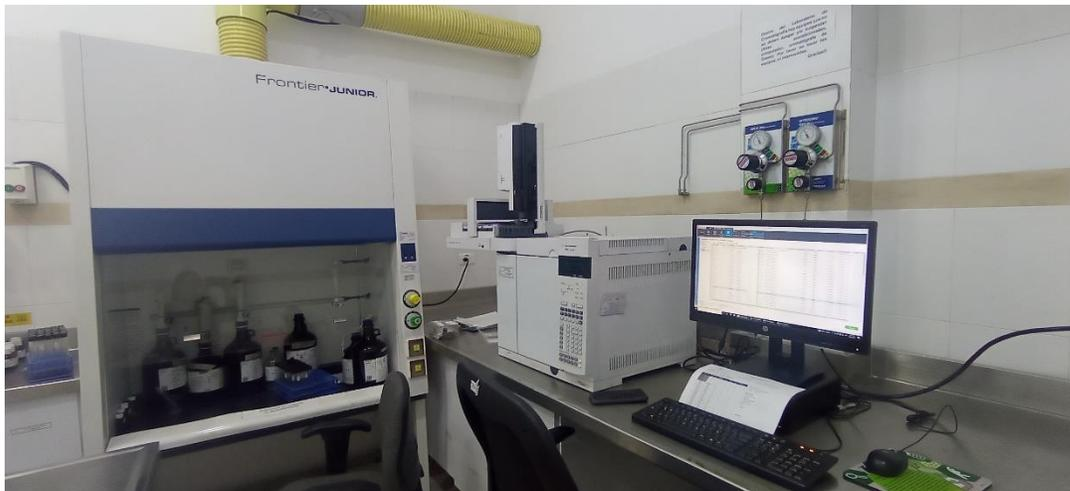
CENS cuenta con laboratorio ambiental acreditado por el IDEAM bajo el método de identificación y cuantificación de PCB's en líquidos aislantes por Cromatografía de Gases ASTM D 4059-00 (R2018), siendo pioneros a nivel regional en la prestación de sus servicios a clientes internos y externos con alta calidad y desempeño.
