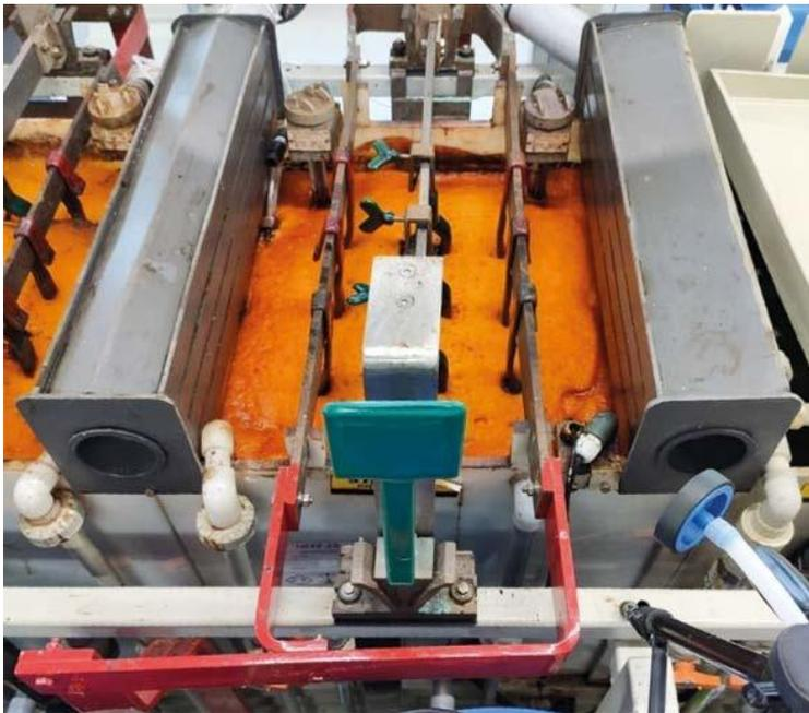
Generación de niebla ácida de cromo en el baño de ácido crómico por reacción electrolytica.
