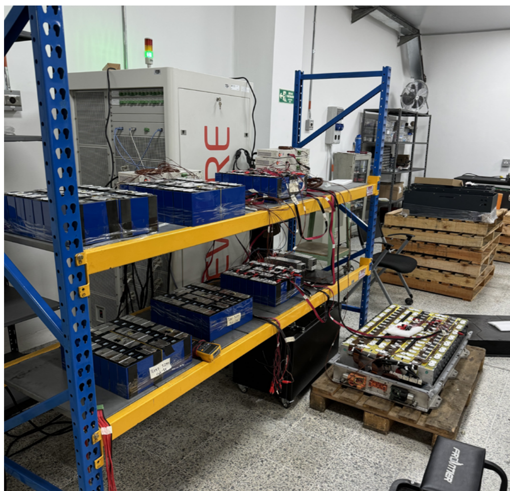
Figura 7: Testeo de ULIB por medición y análisis computarizado de datos de desempeño (Fotografía de los autores tomada en la planta de Tronex en Medellín).
