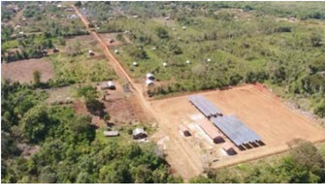
Desmonte de vegetación en una planta solar híbrida, (Solar - Diésel) con una potencia instalada de 168 KW pico, en Bolivia (Fuente: INEL Colombia, Proyecto El Remanso , Bolivia)
