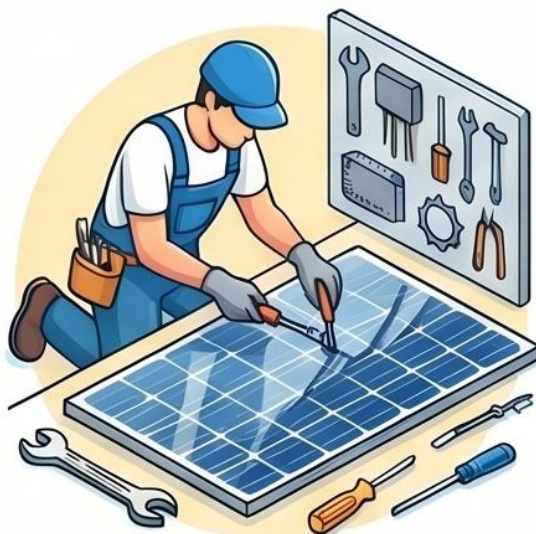
PASO 1: DESENSAMBLE MANUAL. Retiro de marcos de aluminio, cables, convertidores (10% del peso).
